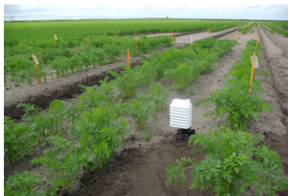
Exemple de capteurs à l'échelle du couvert végétal dans un champ de carotte, en complément des capteurs à l'échelle de la parcelle pour l'étude de l'effet de l'environnement sur les composantes de la qualité nutritionnelle et organoleptique du produit.
