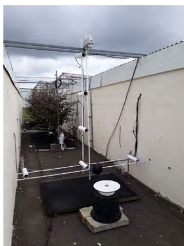
Figure 1 : à gauche : instrumentation microclimatique dans la rue Canyon, avec au premier plan les sondes de température et d'humidité de l'air et les capteurs de rayonnement dans la zone non-végétalisée ; à droite : Mesures réalisées sur les arbres (transmission du rayonnement PAR et température de feuilles) dans les modalités végétalisées.
