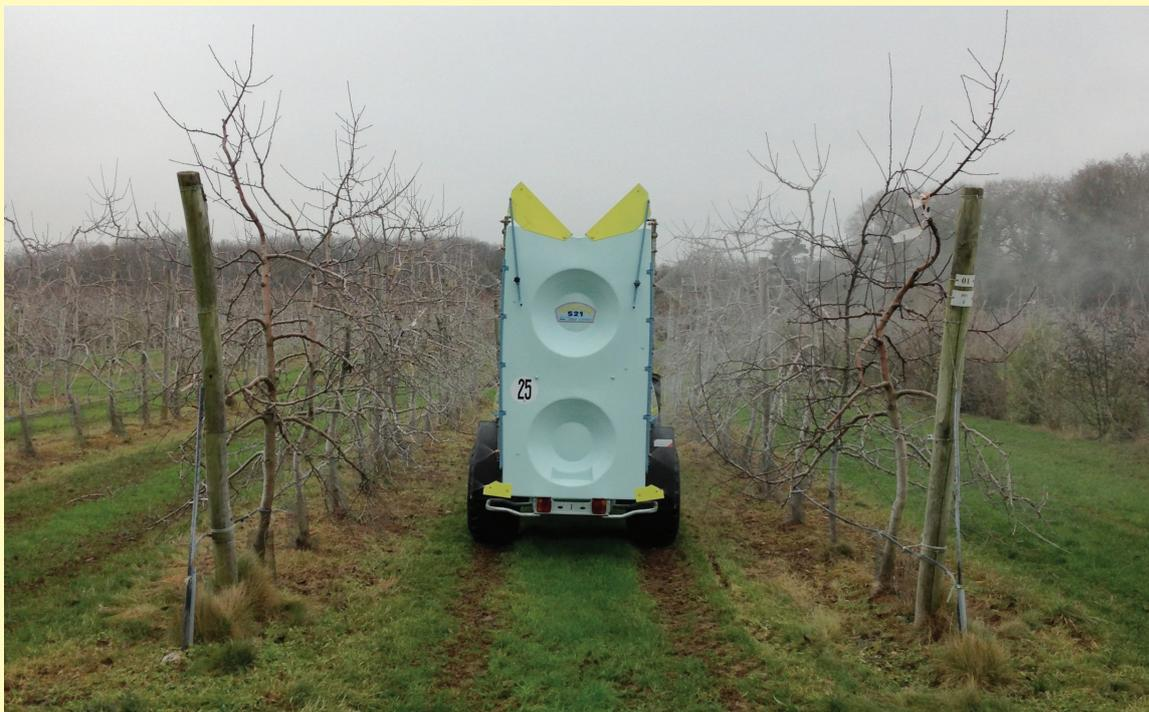
Essais de buses antidérive (à droite buses classiques l'embrun de traitement est visible, à gauche buses antidérive, pas d'embrun visible)
