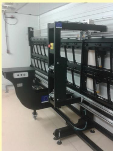
Le système ElonCam installé en chambre de culture dans les locaux de la SNES-GEVE
