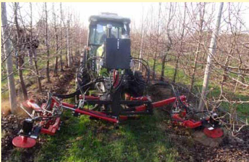
Appareil de désherbage mécanique
