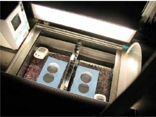
Dispositif d'analyse de germination des semences en cryostat
