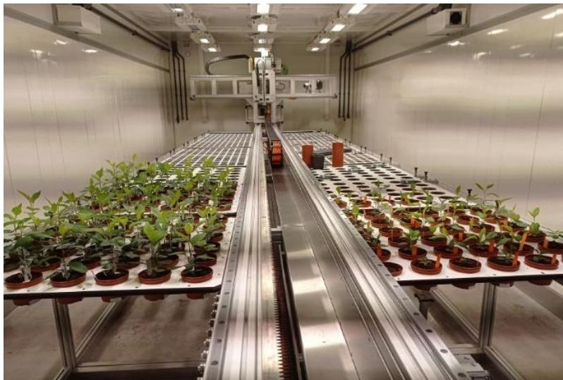
Photo de l'installation PHENOBEAN 1 en cours d'expérimentation lors du projet CLIGDI. Essai de culture et d'imagerie sur pommiers semis.
